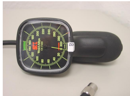
Fig. 8: Medidor de estanqueidad
